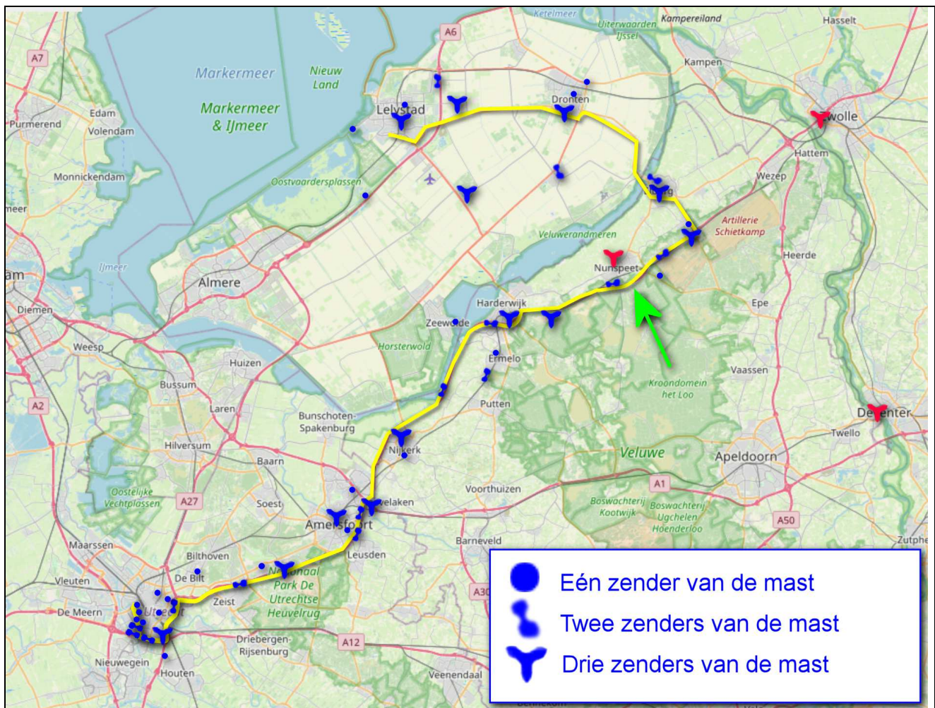
Figuur 6. Hier nog een ander kijkje in de keuken. Hier zijn alle locaties afgebeeld van de zenders, die de gemeten dekking zouden hebben opgeleverd. Doorgaans hangen drie zendinstallaties aan dezelfde mast. Soms zijn ze alle drie teruggevonden, soms maar twee en vaak ook maar één van de twee of drie. In meerdere gevallen zien we zenders aangemeld, die achter andere zenders liggen. Van de zenders met drie aan één mast geldt eigenlijk automatisch dat één van de zenders niet rechtstreeks op de route kan zijn gericht. Dat zijn situaties, die erop wijzen, dat het begrip calling-channels ook de gescande nabuurscellen insluit. In rood zijn de zendmasten aangegeven die een zender van kanaal drie huisvestten. Deze kwamen alle drie in dit stuk niet voor. De zender van Nunspeet zou normaal gesproken wel in beeld moeten zijn geweest, maar geen van de drie zenders aan deze mast werd zichtbaar.
