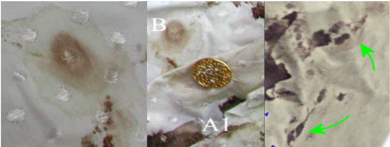
Voorbeelden van vlekken op de blouse die daar pas na berging van het slachtoffer verschenen en die aanwezig vocht verraden. In de 'linker' vlek varieert de kleur tussen roodachtige en bruinige tinten, wijzend op verschillende samenstellingen met IJzer(III).
