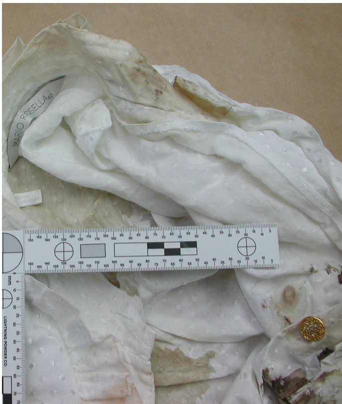
Verschijningsvormen van IJzer(III)-verbindingen, allemaal op dezelfde blouse, van donkerrood, via roze en bruin tot groen.
